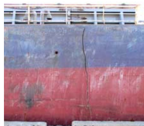
サブスタンダード船の実例（いずれも Tokyo MOU database より） (左：船側外板に大きな亀裂が入った船舶、右：貨物艙の消火管から漏水する船舶)
